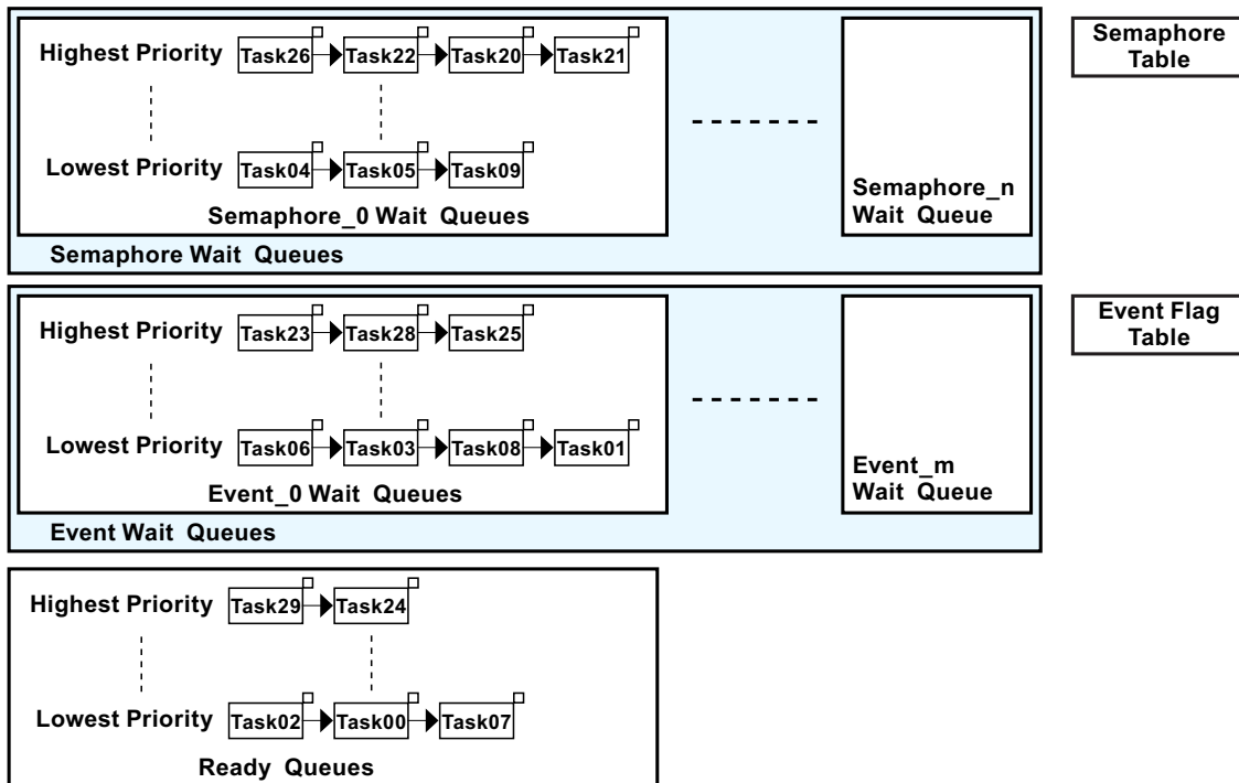
Figure 2.2: RTOS の構造
