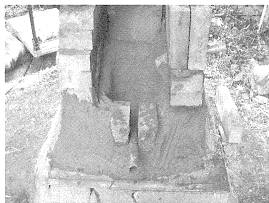
写真 2 土を塗り、羽口をつけた製鉄炉
