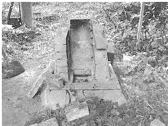
写真 1 製作途中の製鉄炉（土台の高さは 20 cm）
