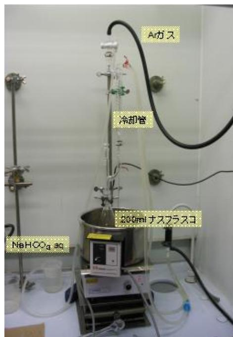
図 2-20. クロロスルホン酸によるスルホン化のための反応装置
