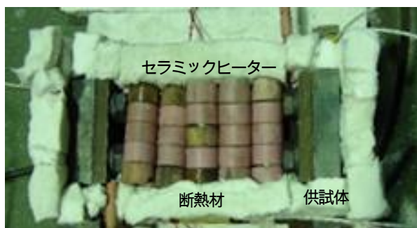
図-3 セラミックヒーターによる応力除去焼鈍
