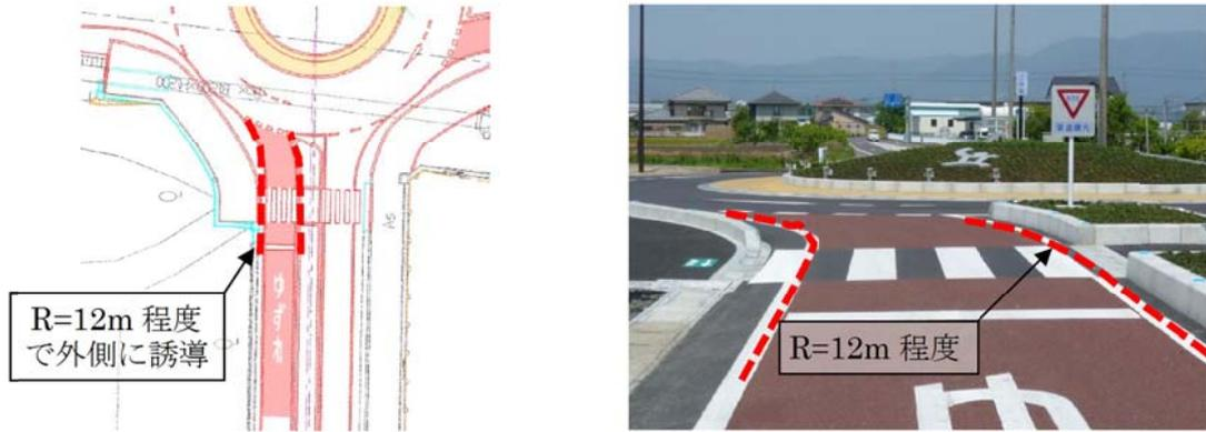
図-3.2 逆走防止対策の流入部における幾何構造の工夫例(守山 Case4)
