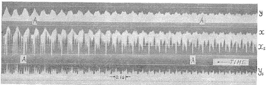
FIG. 7.5. Vibratory waves (Ball bearing #1200 used,  $\omega=1925$  rpm,  $\omega : P_2 : P_3 \doteq 50 : 81 : 19$ )
