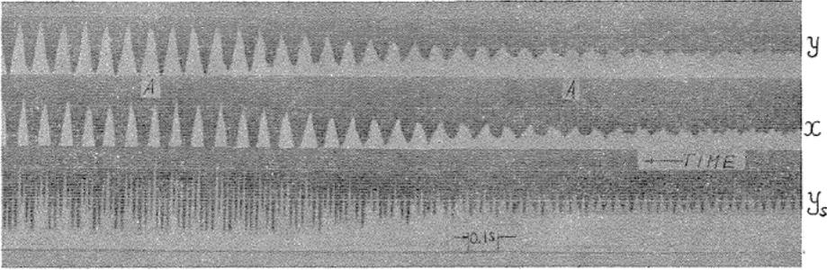
FIG. 7.9. Vibratory waves (Ball bearing #6200 used,  $\omega=2033$  rpm,  $\omega : P_2 : P_3 \doteq 47 : 75 : 19$ )
