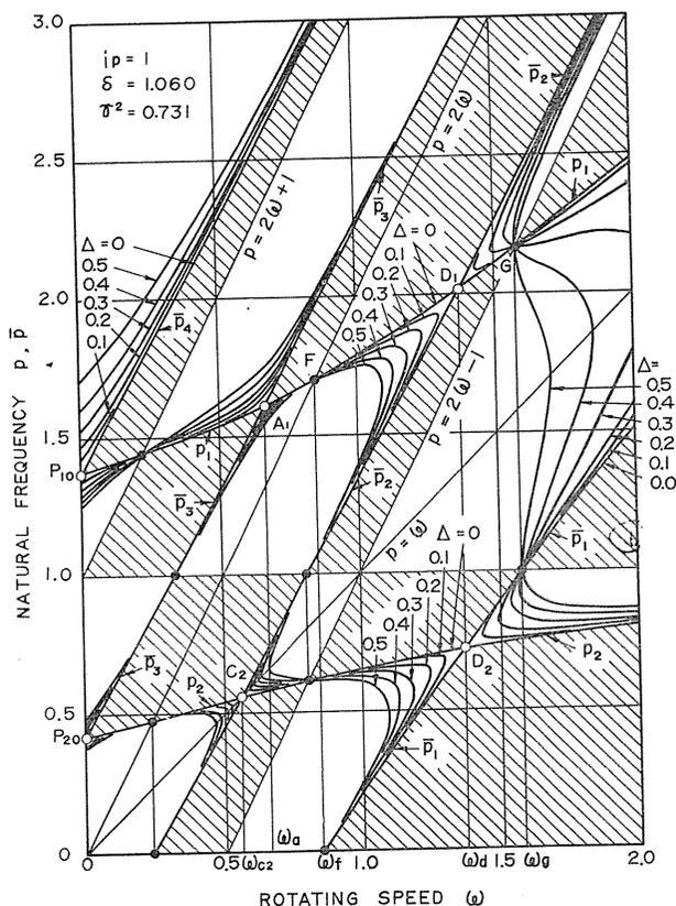
FIG. 6.2.  $p-\omega$  diagram for  $\Delta=0, 0.1, 0.2, 0.3, 0.4, 0.5$ .
