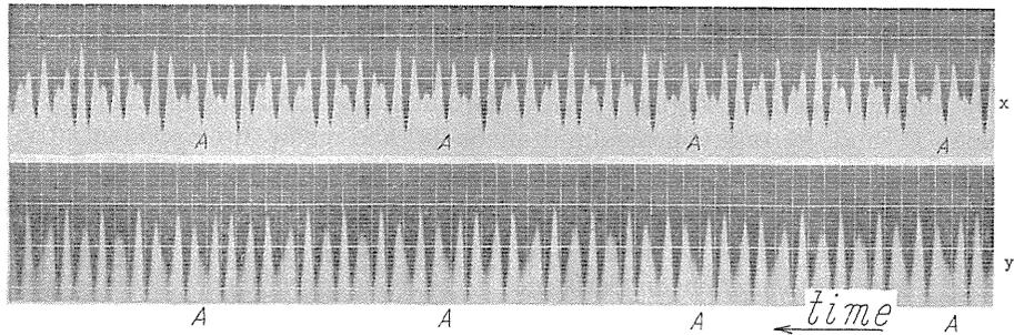
FIG. 5.8. Vibratory waves ( $a : b = 1 : 4$ ,  $\varepsilon \approx 0$ ,  $P_2 : P_1 : \omega \approx 13 : -19 : 16$ )
