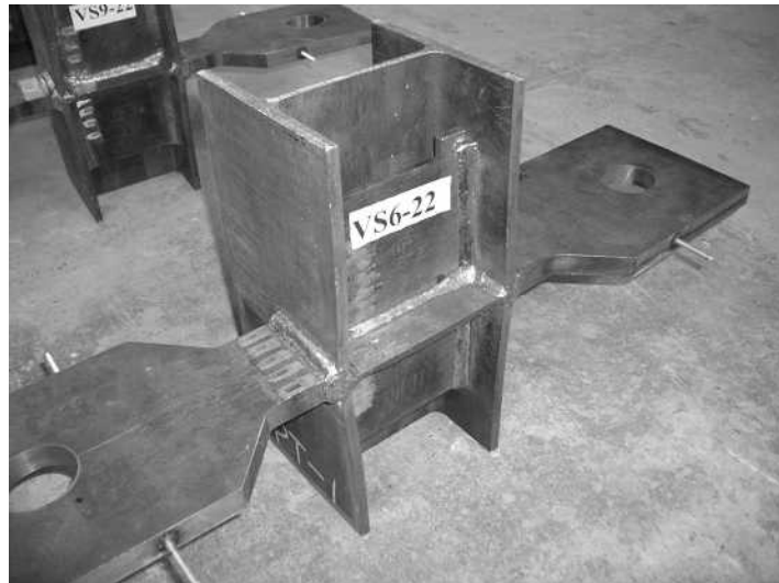
写真 5.2 実験後の変形状態（試験体 VS6-22）
