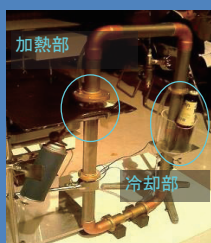
熱音響現象を利用した冷凍機(パーペキュウラー)
