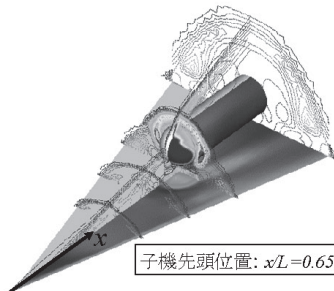
Fig. 3 CFDによるTSTO周りの空間圧力分布
