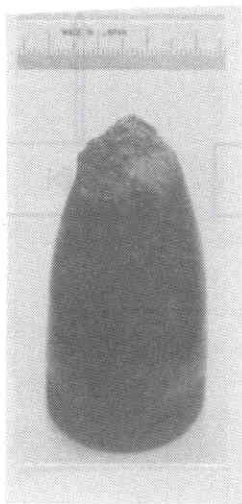
写真 6-9 プラグの損傷状態
