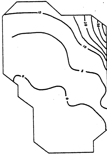
図-5.10 濃尾地下水モデル表層に与えた不圧地下水頭分布 (T.P.基準 m)
