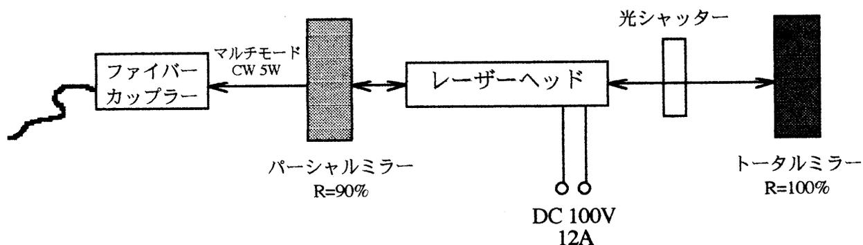
図2. YAGレーザー発振器ダイアグラム
