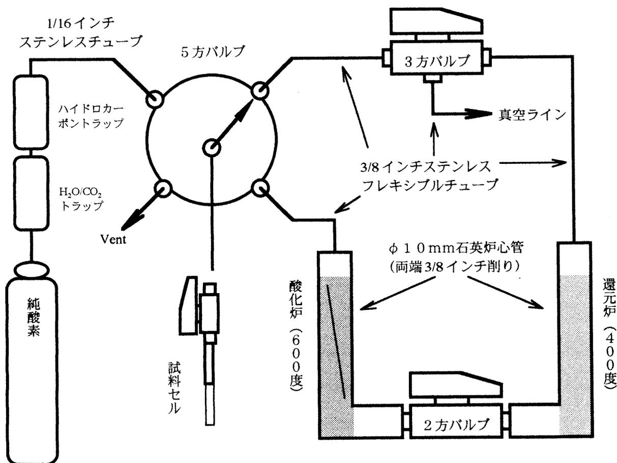
図1 ガス導入・精製装置の概略図
