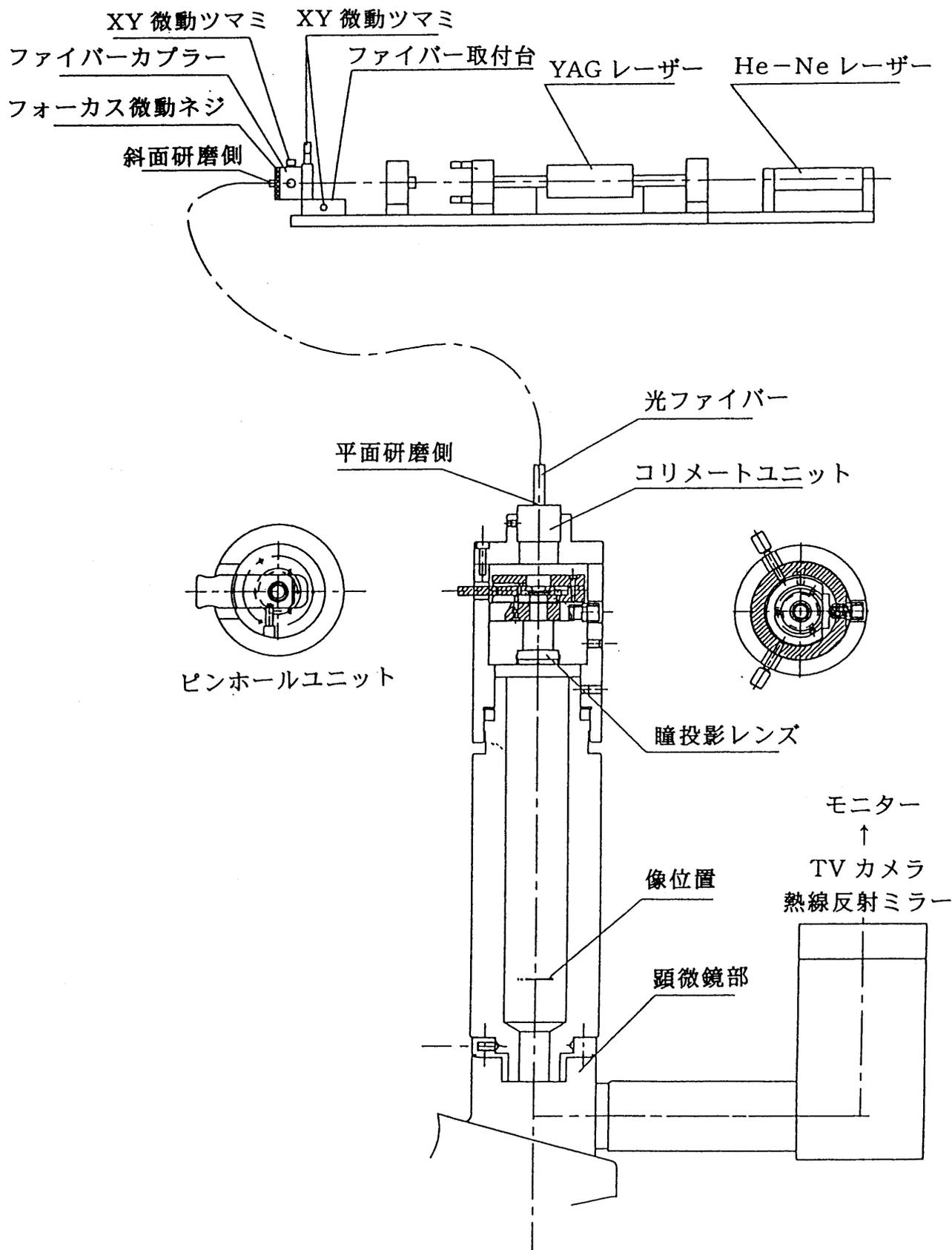
図 1. 赤外レーザー照射装置の概略
