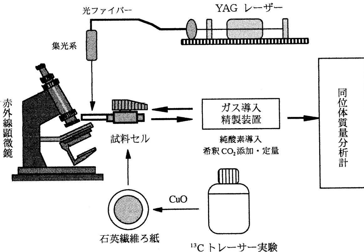
図1 LASMMA システムの基本構成
