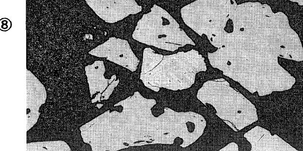
PHOTO.1 砂鉄の顕微鏡組織（荒尾市関川、岩本橋周辺） Microscopic organization of iron sand
