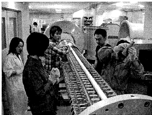
写真 2 高電圧の整流・昇圧装置の点検
