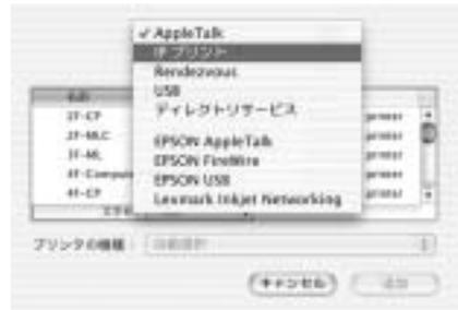
“IPプリント”を選択すると、このようなウィンドウが開く。「プリンタのアドレス」には、プリンタ自身のIPアドレス(またはFQDN)を指定するか、UNIX系のlpdサーバのIPアドレス(またはFQDN)を指定する。UNIX系のlpdサーバを用いるときは、サーバ上のキュー名を指定する必要があるだろう。また、lpdの場合には、プリンタの機種選択を自動設定できないため、プリンタの機種を選択しておく必要がある。
