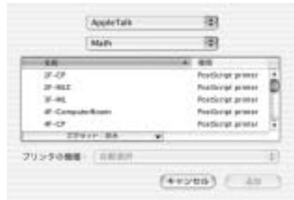
プリンタへの接続形態としては、“IPプリント”(TCP/IP (lpd) を用いてプリンタに接続する)，“Rendezvous”(Bluetoothを用いてプリンタに接続する)，“USB”(USB接続されたプリンタを利用する)，“ディレクトリサービス”(LDAP, NetInfoなどからプリンタ情報を得て、TCP/IP (lpd) を用いてプリンタに接続する)を選択することが可能である。
