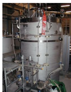
図1-10 2.9 MJ 系統安定化用 SMES および 9.6 kA 導体構造
