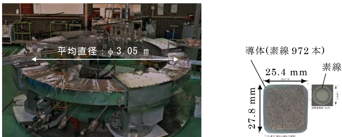
(a) 1/2 ユニット強制冷却型超電導コイル外観 (b) コイル導体・素線断面
