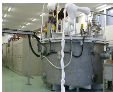
図1-11 10.5 MJ 負荷変動補償・周波数調整用 SMES および 10 kA 導体構造
