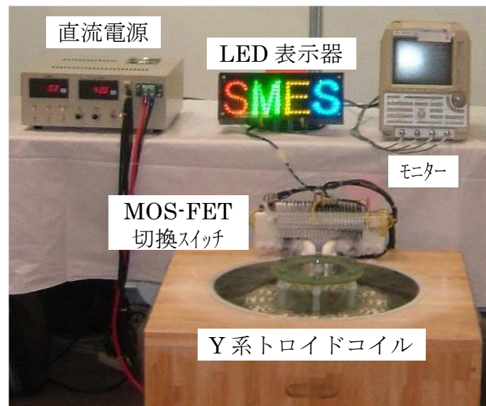
図 5-24 トロイド型 Y 系 SMES モデルの充放電繰り返し運転状況
