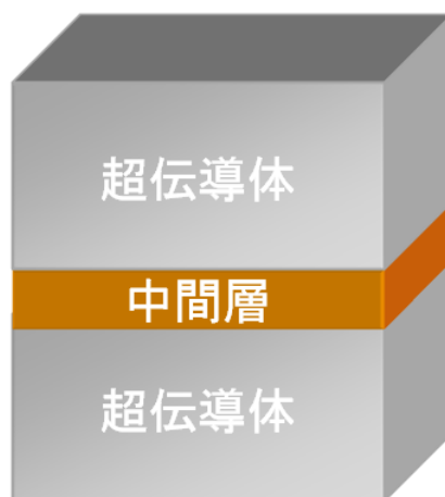
図 1.5 ジョセフソン接合の構造。超伝導体の間に薄い中間層を挟んでいる。中間層が絶縁体の場合その厚さは 1 nm 程度とっている。
