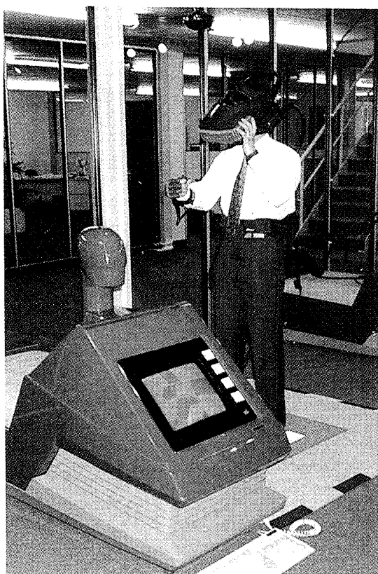
図2 人工現実感の装置 (英国 W. Industries 社)
