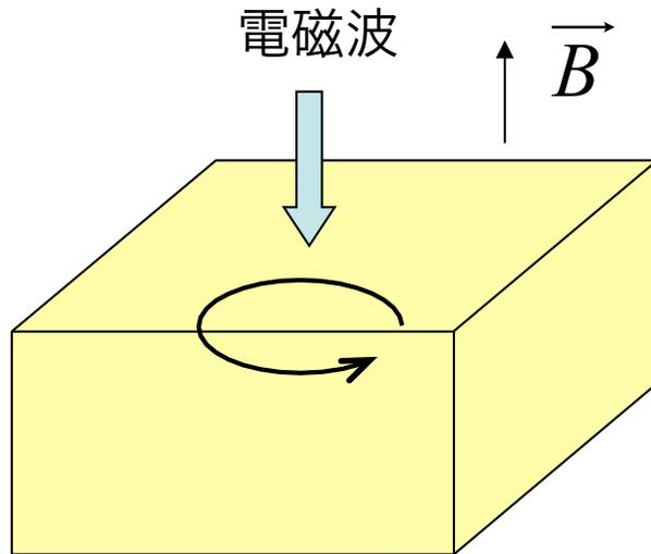
$\omega = \omega_c$  で電磁波の吸収が大きくなる
