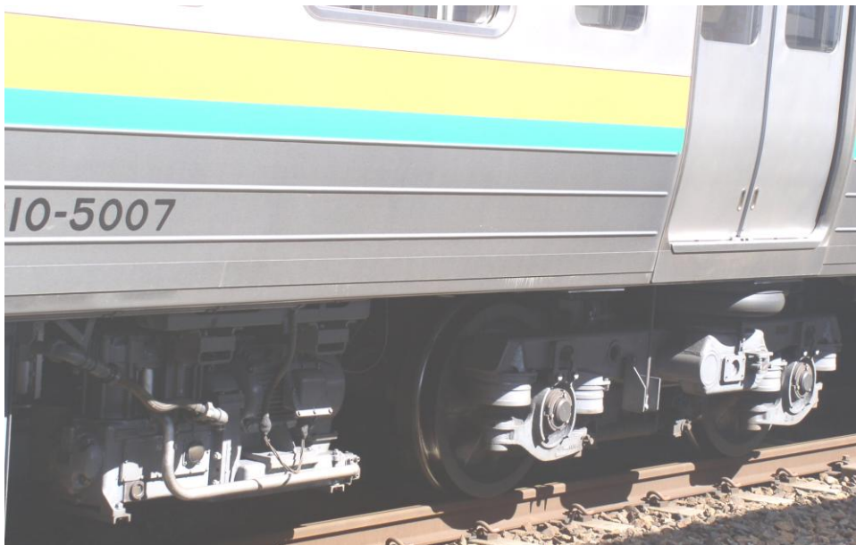
6-5; Example of a soft Spring (Air Damper), a passenger car, @ JR-Kozoji Station, 通勤電車の軟らかい空気バネ（ドアの下に見える円盤状の物）、固有振動数が低いので、 線路からの振動が客室まで伝わり難い。
