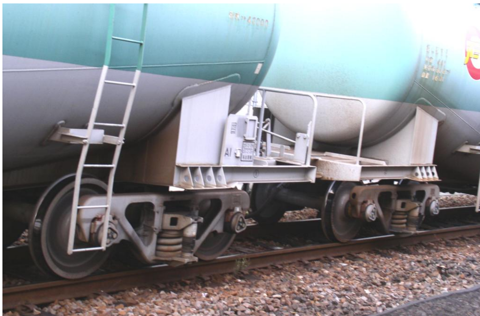
6-4; Example of a hard Spring, a Freight Train, @ JR-Ozone Station, 貨物列車の硬いバネの例（鉄製のコイルバネ、これが無いと車輪と線路が損傷する）
