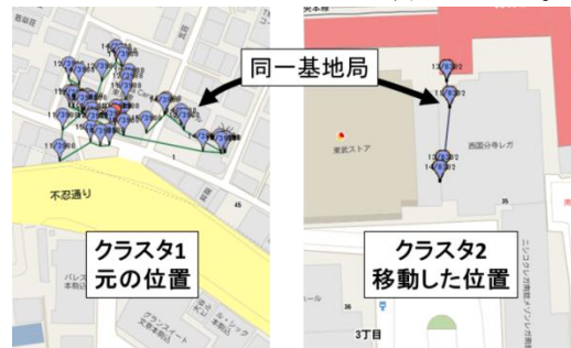
図2 移動した基地局の観測点分布 (左: 移動元、右: 移動先)
