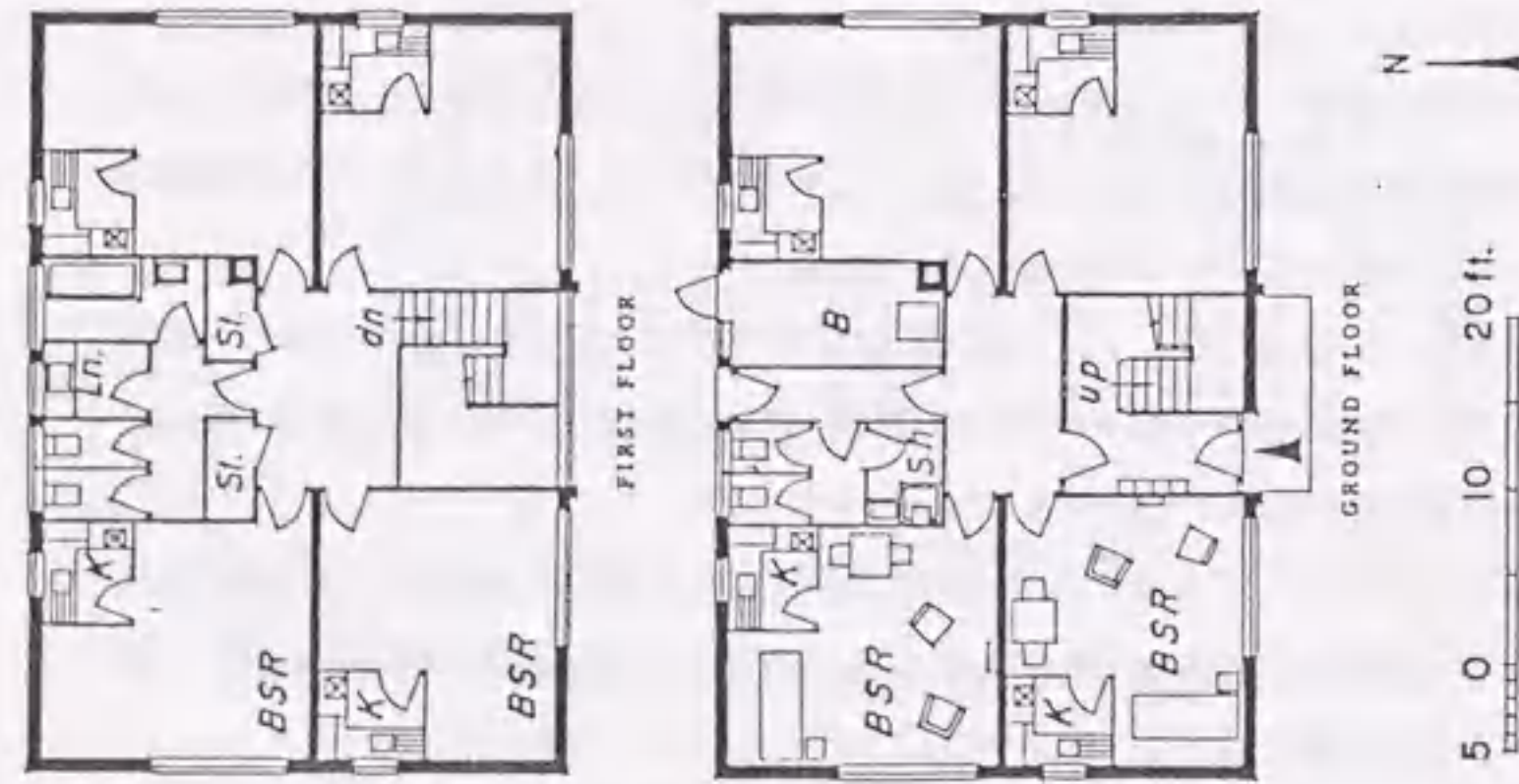
図6-20 1960年当時推奨された小規模住棟計画のひとつ (単身高齢者向け住戸8戸の計画、MHLG:More Flatlets for Old People, HMSO, 1960より)
