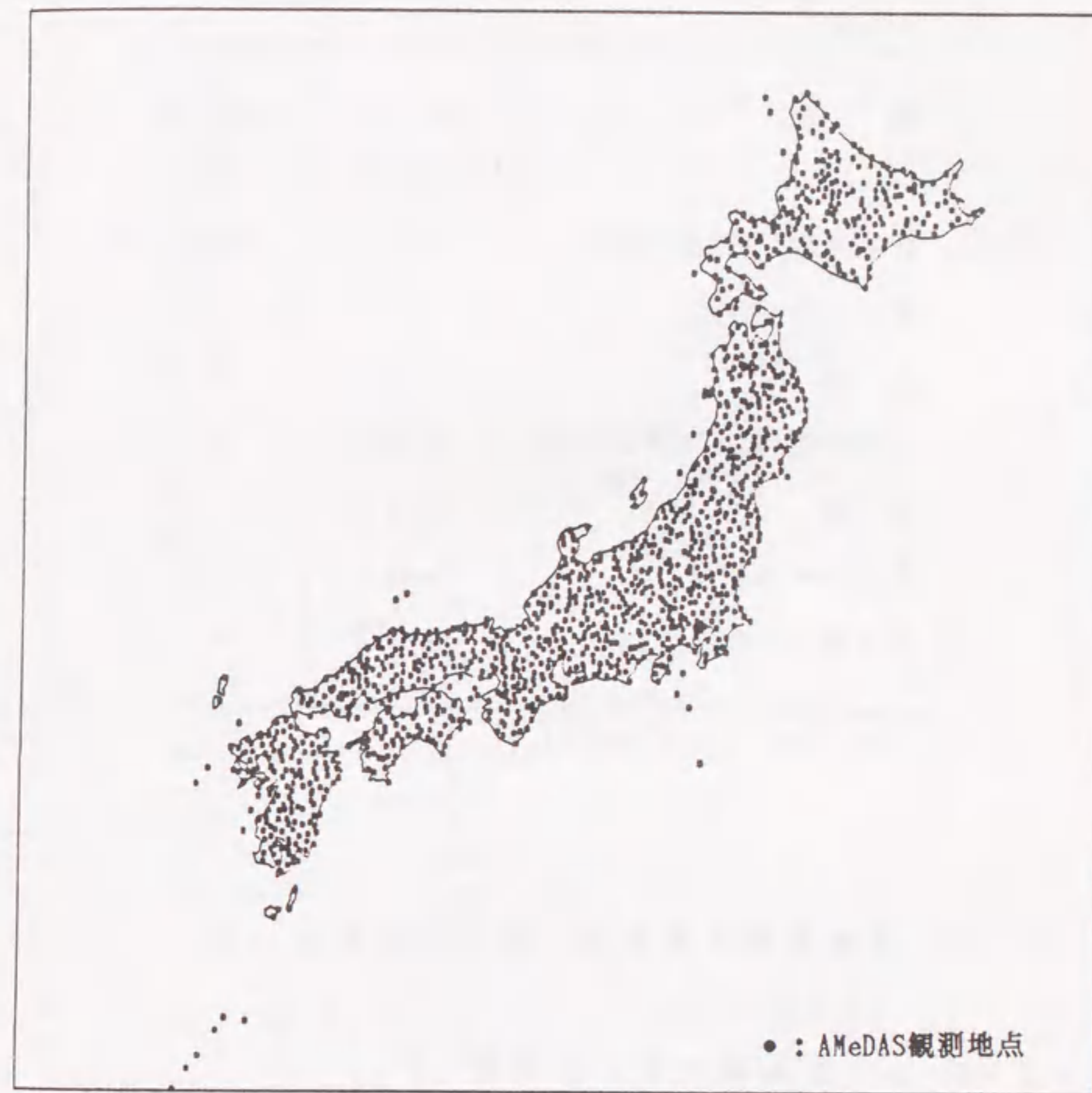
図 2・1 AMeDASの全観測点 (全観測点数:1,318ヶ所) (平均観測点間隔:約17km)
