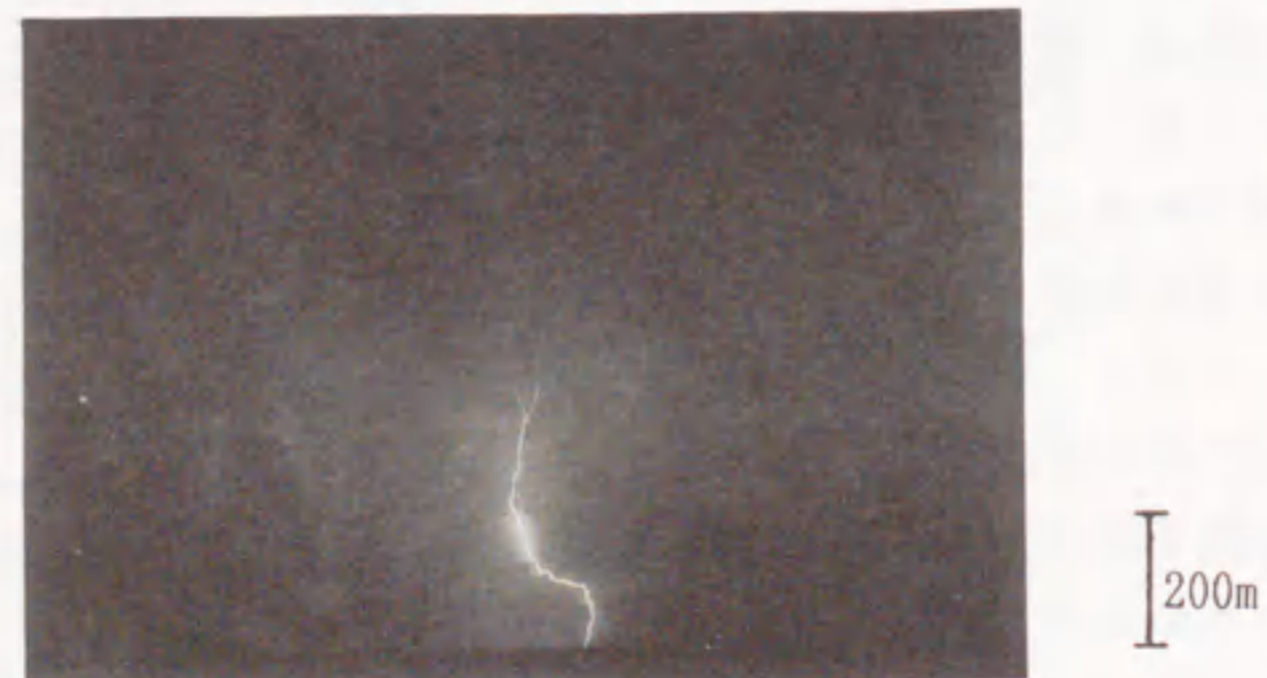
図6.5 制御所近傍の道路への異常誘雷放電全景写真 (No. 82-16, 1982年12月12日, 雷雲: 負) (推定雷撃電流: -30.0kA)
