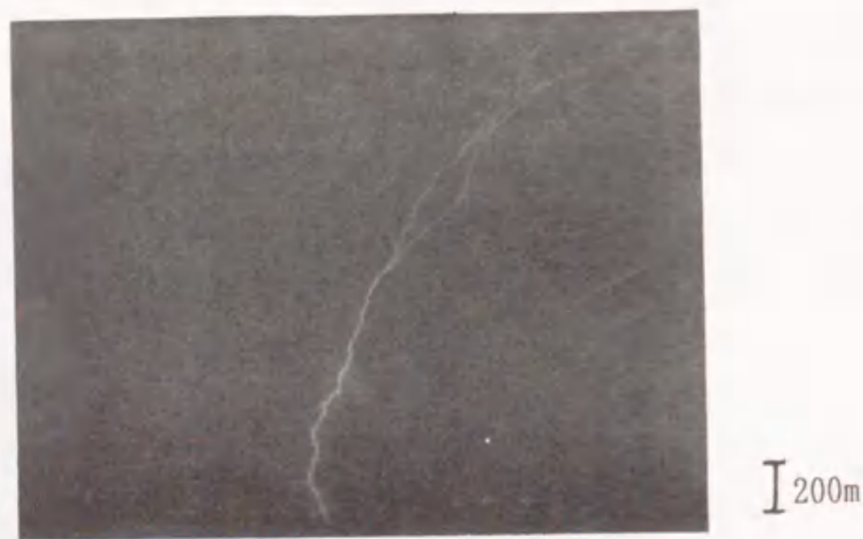
図6.11 発射台を直撃した異常誘雷放電の全景写真 (No. 81-07, 1981年12月2日, 雷雲: 負) (推定雷撃電流: -3.8kA)
