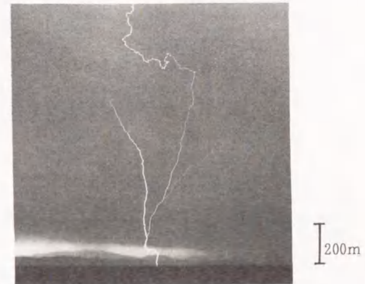
図6.8 2.2km離れた地点から撮影された異常誘雷放電No. 79-09の全景写真 (1979年12月25日, 雷雲: 負) (推定雷撃電流: -41kA)
