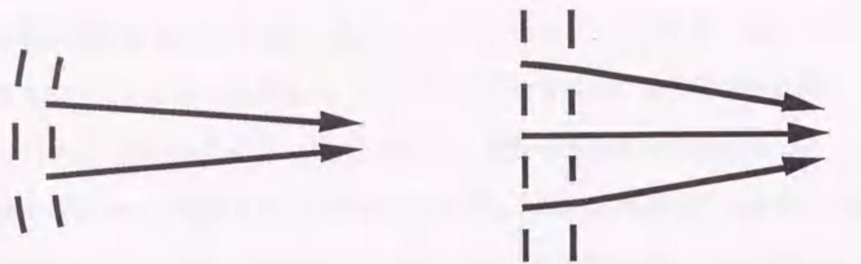
a)電極を湾曲させる方法 b)電極孔の中心軸をずらす方法。
