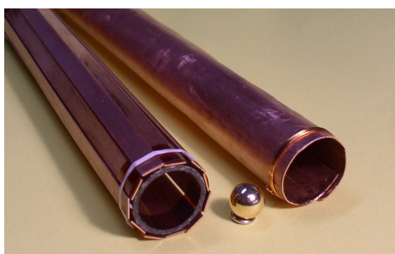
図2. 左は、スリット入り銅パイプ（細い銅板を互いに絶縁してパイプ状に並べた筒）。右は、薄肉銅パイプ（スリット入り銅パイプと同じ銅板を丸めたパイプ）。
