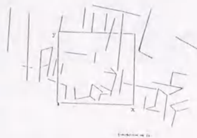
図 8.11 露頭面の卓越した不連続面
