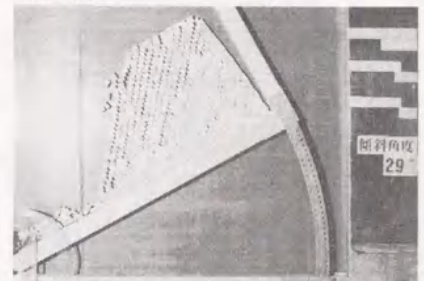
千鳥状 斜面角度 45° 成層角度 0° ブロックサイズ(mm) 5x10 傾斜角度 29°
