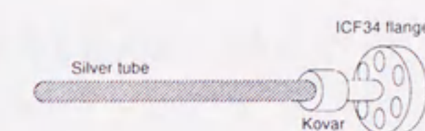
Figure 4.3: 酸素導入のための銀の焼結棒。NEA 表面処理のため、酸素を導入する時にはヒーターとアルミホイルで巻き加熱する。
