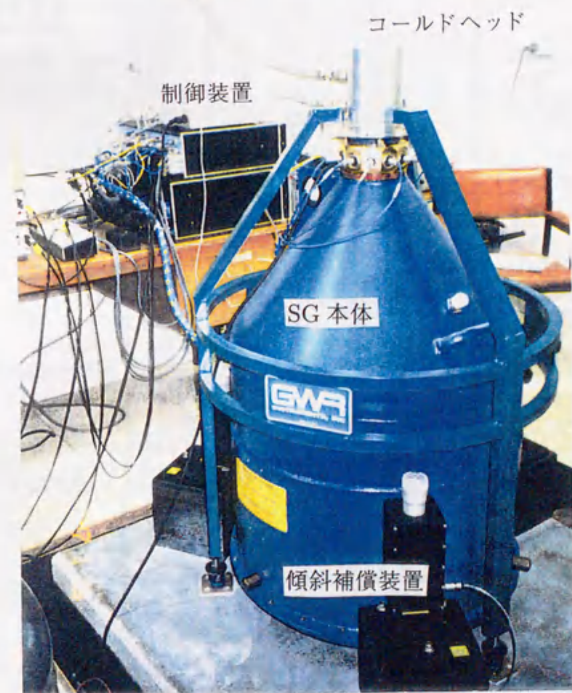
図 2-1-1: 昭和基地 (上: トップマウント方式) と キャンベラ (下: ボトムマウント方式) の超伝導重力計
