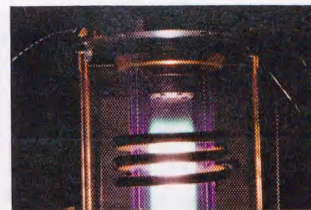
図3.3 高周波誘導熱プラズマトーチ内の熱プラズマ。
