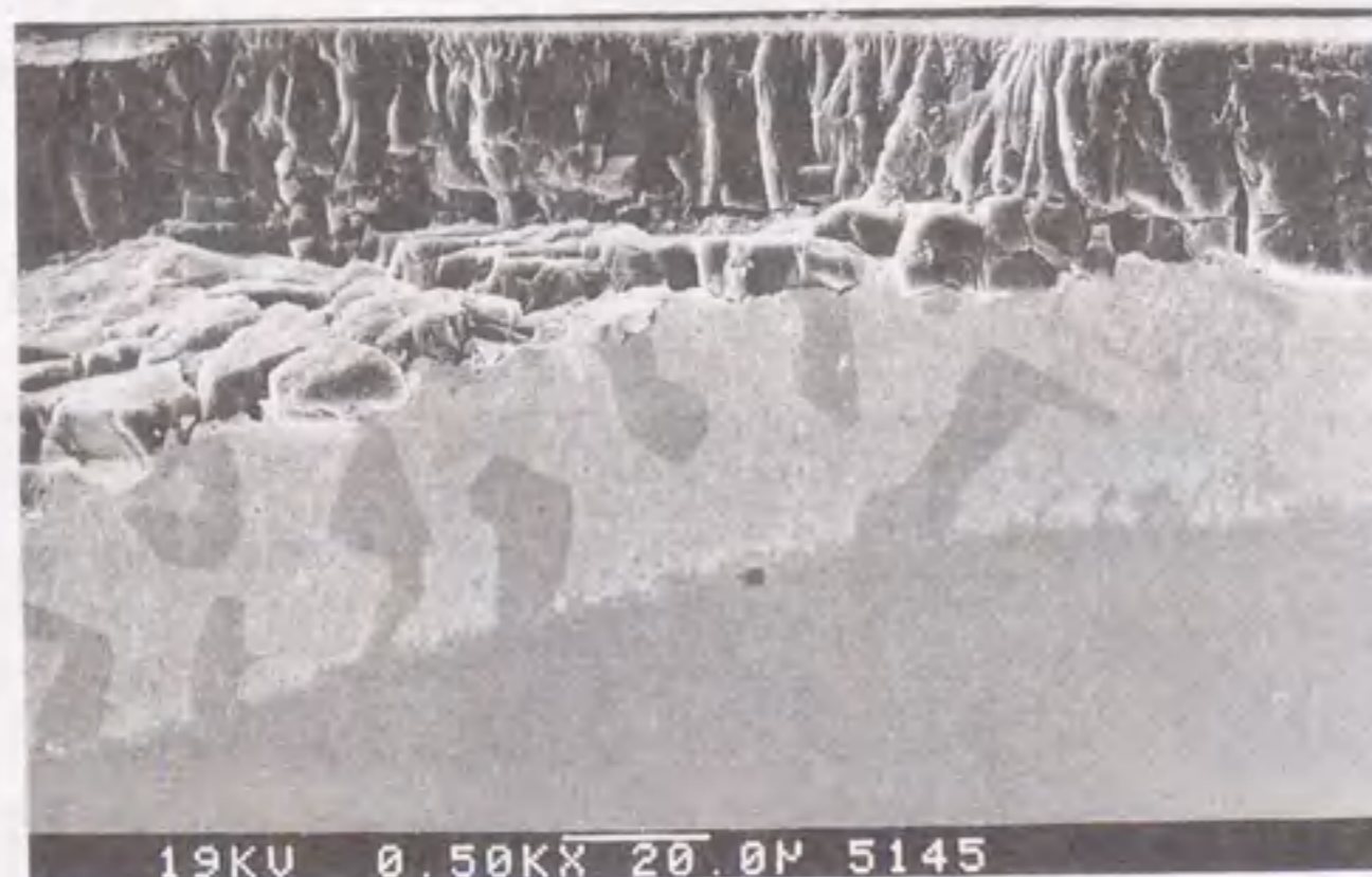
図3.21 反転ろう付したダイヤモンド膜上に荷重980Nで形成した圧痕断面のSEM像（上）とその高倍率像（下）。
