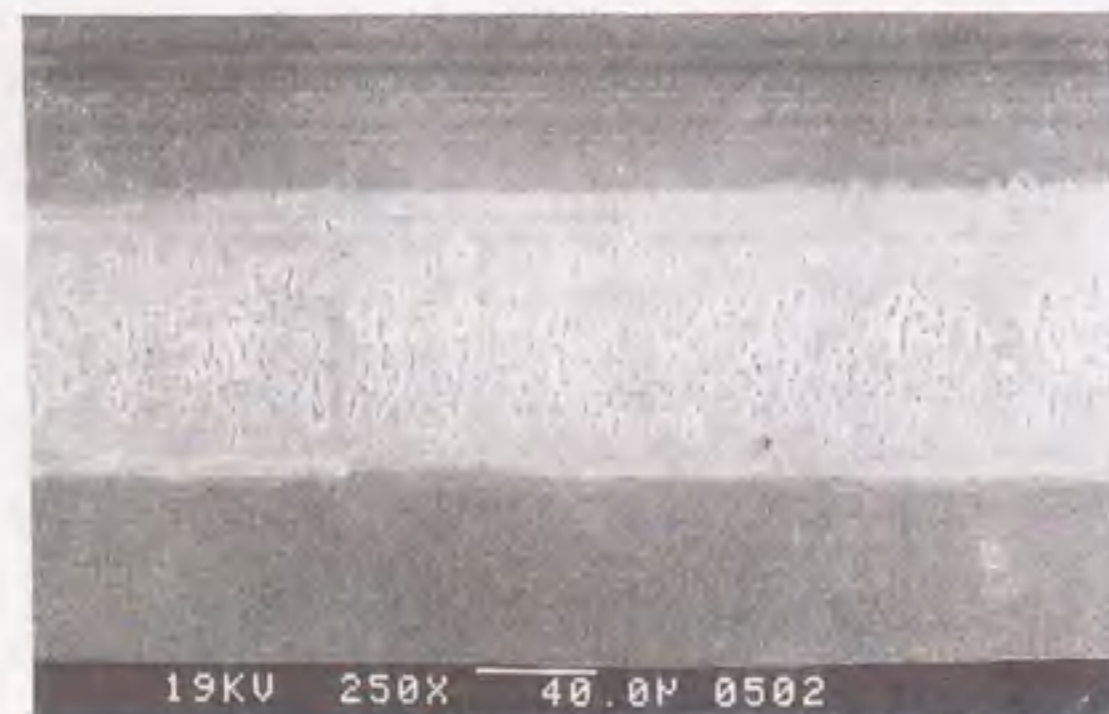
図4.30 SiCボールと摩擦した窒化炭素膜上の摩耗痕のSEM像。(窒化炭素膜形成時の窒素イオン照射エネルギー：600eV)
