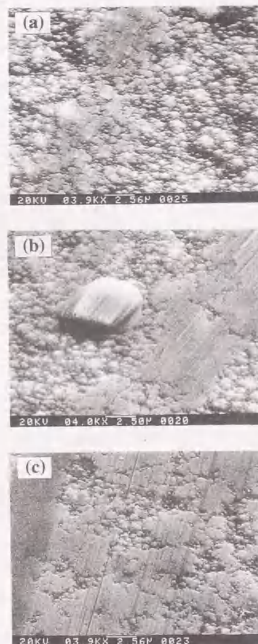
図3.27 SiCボールと摩擦したFilm A (as-depo膜)の摩耗痕のSEM像：(a) 試験時間：1時間、(b) 試験時間：3時間、(c) 試験時間：5時間、(荷重：4.9N、摩擦速度：0.04m/s)
