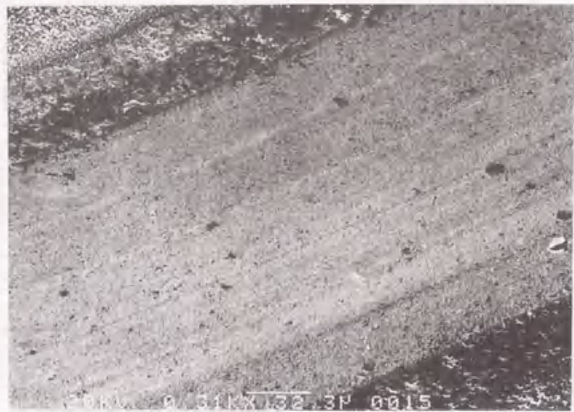
図2.8 荷重4.9Nで40時間摩擦摩耗試験をした後のSiCディスクの摩耗痕のSEM像.
