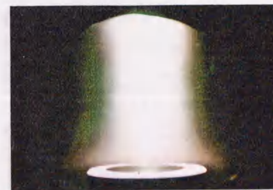
図3.4 反応チャンバー内に伸長した熱プラズマ。
