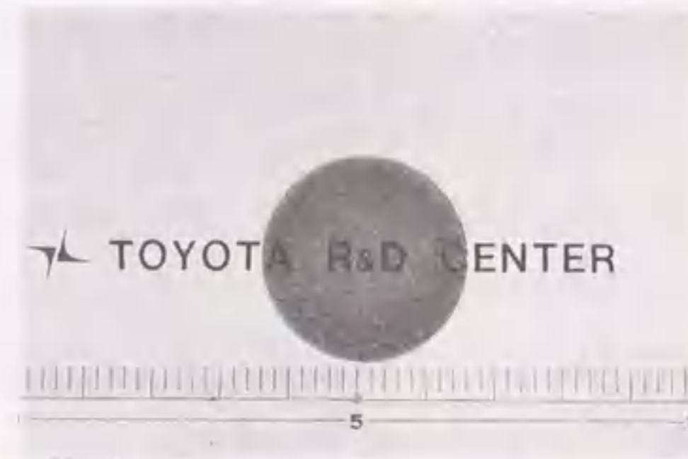
図3.11 高周波誘導熱プラズマCVD法により得られた直径30mm、厚さ30μmのダイヤモンド自立膜。
