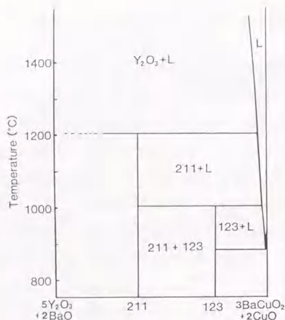
図1.12 Y-Ba-Cu-O系の \text{YBa}_2\text{Cu}_3\text{O}_7 (123)相と \text{Y}_2\text{BaCuO}_5 (211)相を結ぶ線に沿った擬二元状態図 29) .
