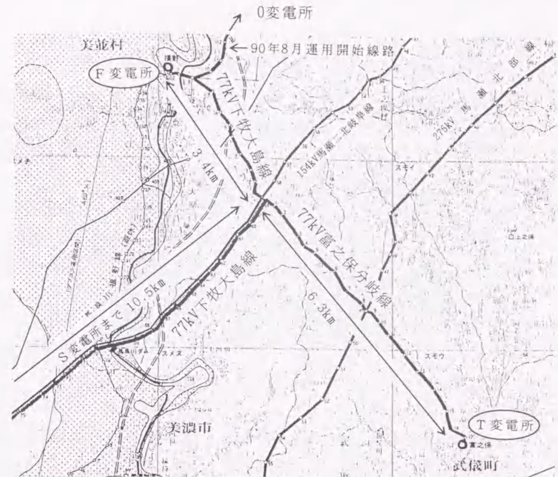
図2.1 変電所侵入雷サージの観測箇所
