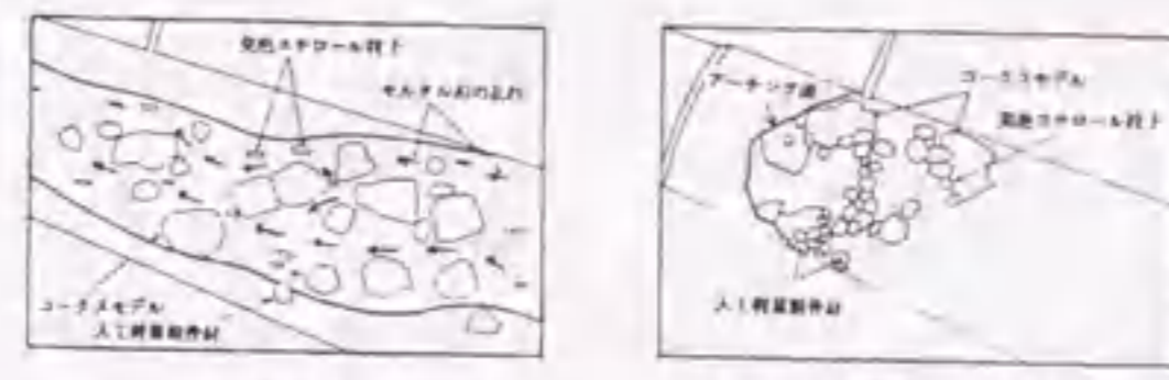
(a) 管内流動状況 (b) 管内閉塞状況
