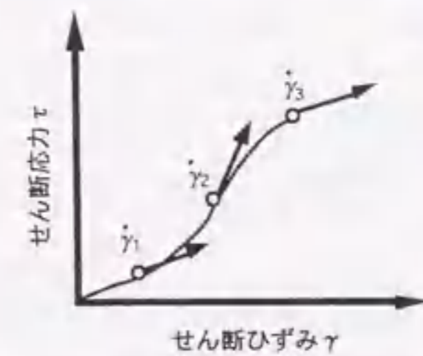
図4.2.15 流動挙動の予測手法の概念
