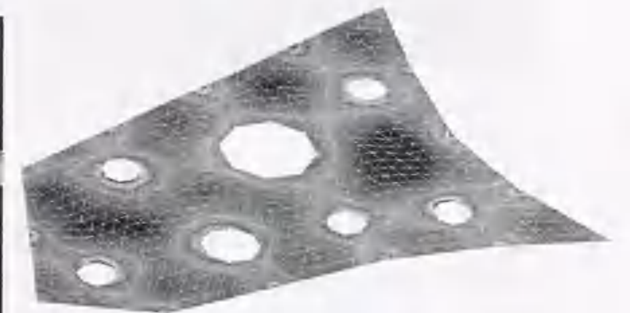
図2.2.3 同左主応力分布状態(FEM)
