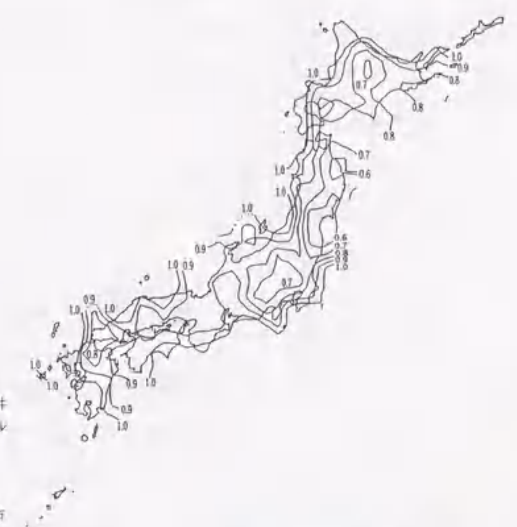
図2.3.2 50年最大値の変動係数マップ 14) (上下限値を有する分布による)
