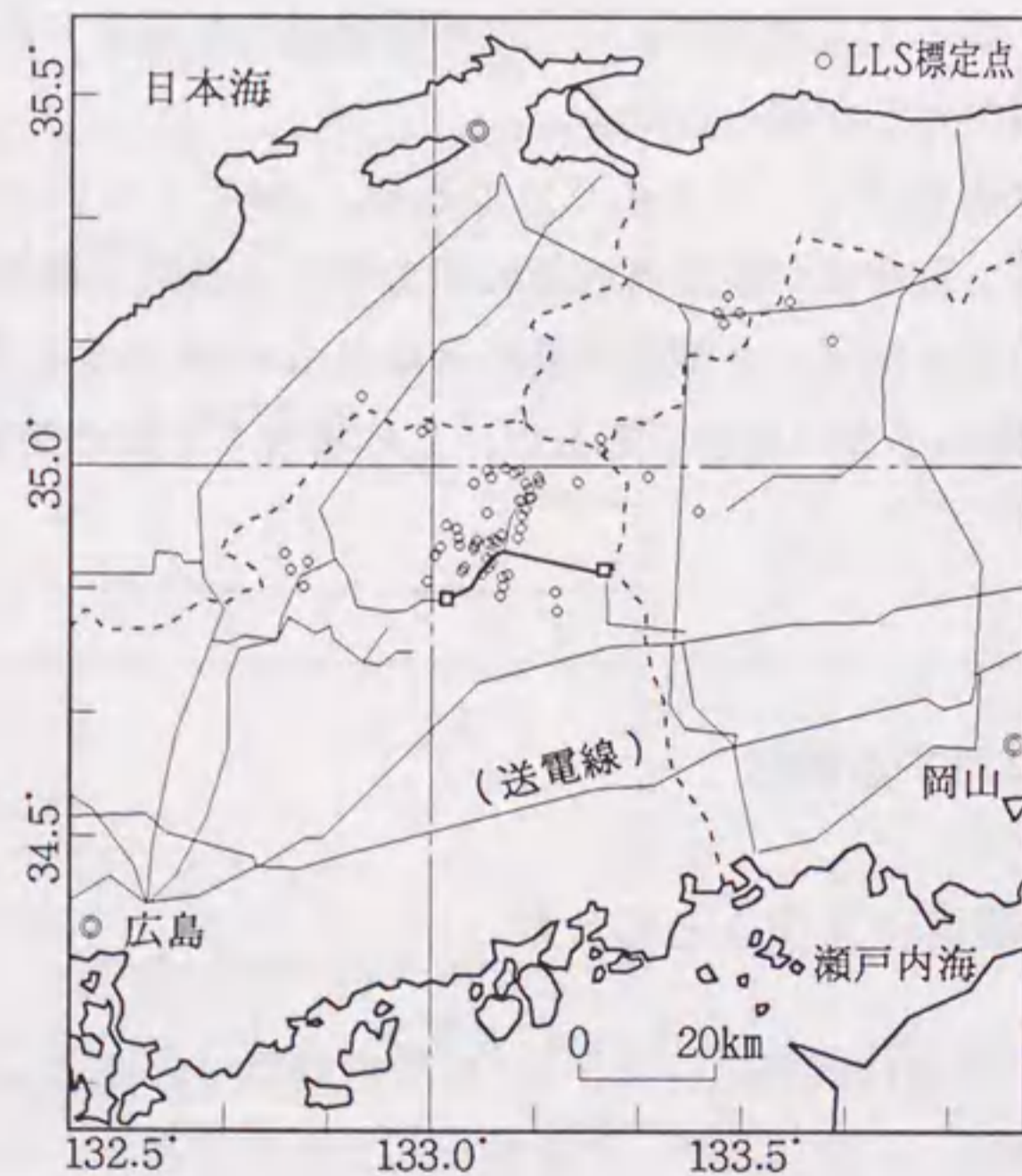
図7.10 OPGW偏波変動とLLSの検出時刻の一致した落雷のLLS標定位置
