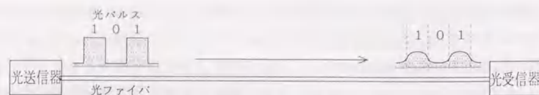
(a) 現在の光通信方式 (光強度変調/直接検波)
