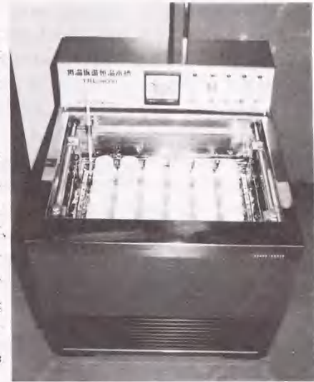
写真-3.1 溶出実験状況
