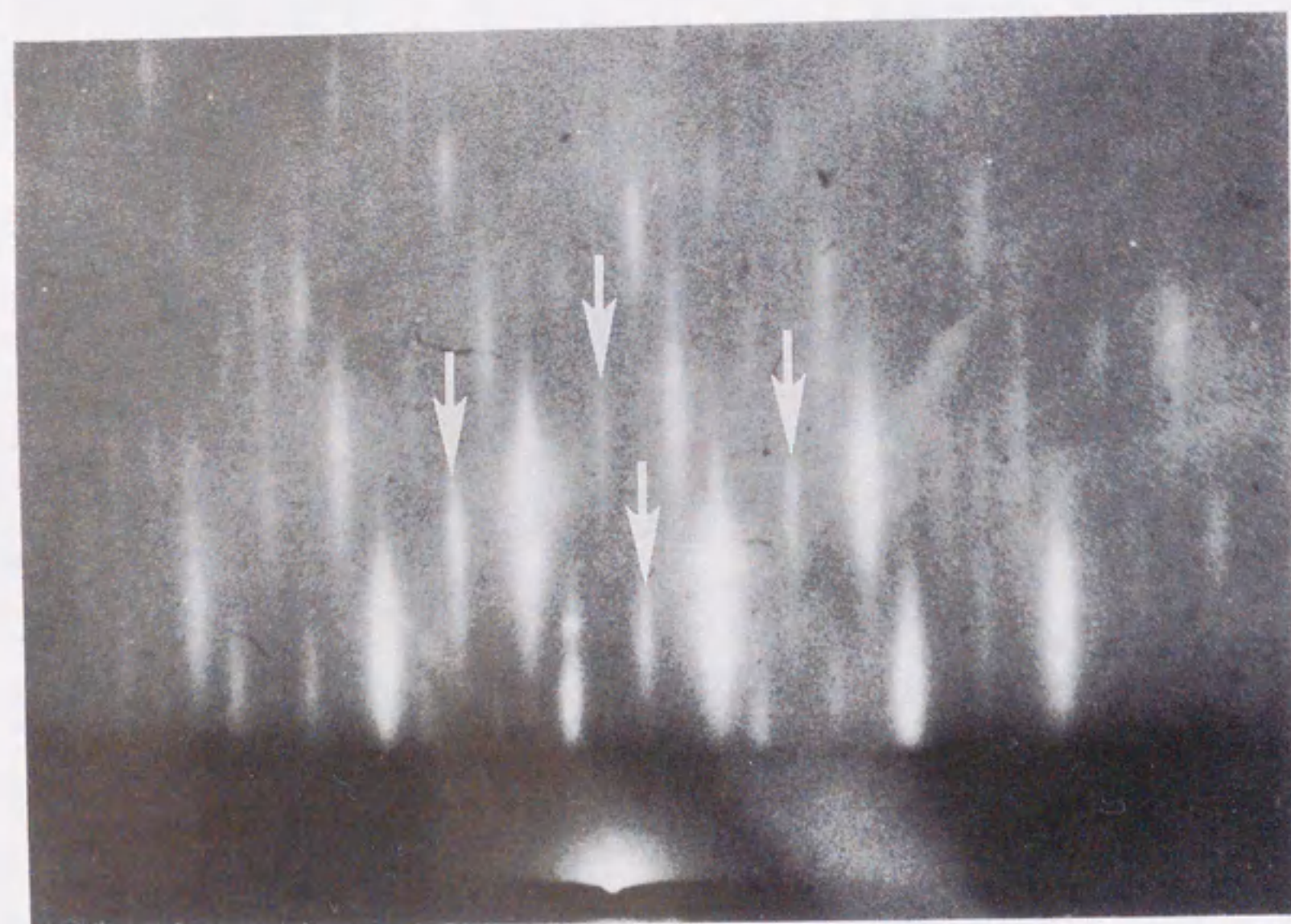
図3-30 (811) Si 基板上の Ge 膜成長の第2段階に対する RHEED 像。矢印は、(111)面の2倍周期秩序積層構造に由来する超周期回折点を示す。
