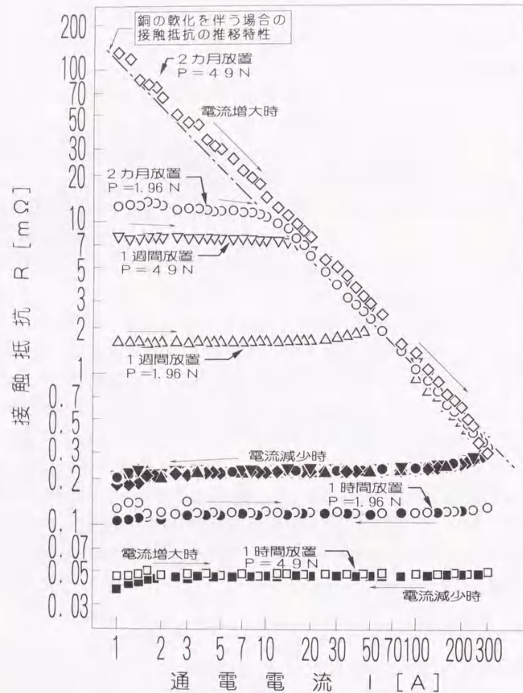
図 6.14 大気中に放置した銅接触子の接触抵抗と通電電流との関係
