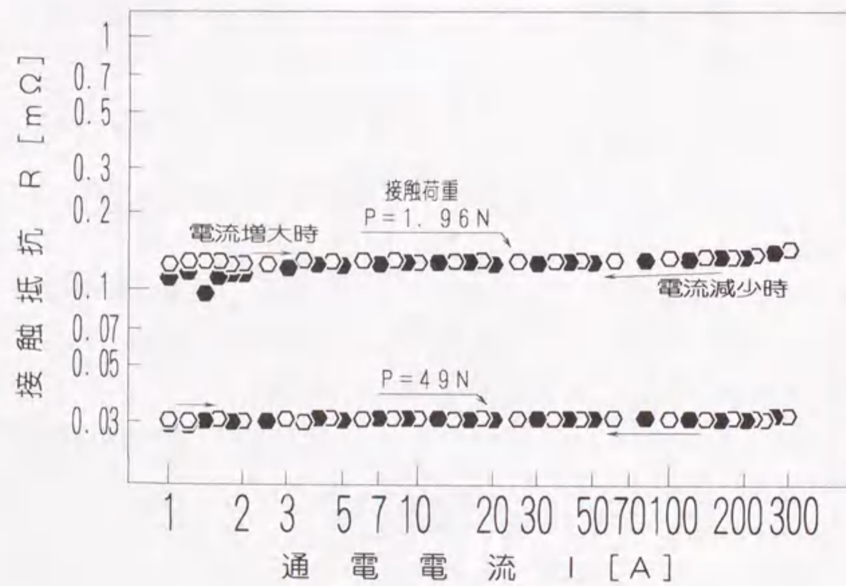
図 6. 6 銅接触子を用いた 接触抵抗と通電電流との関係
