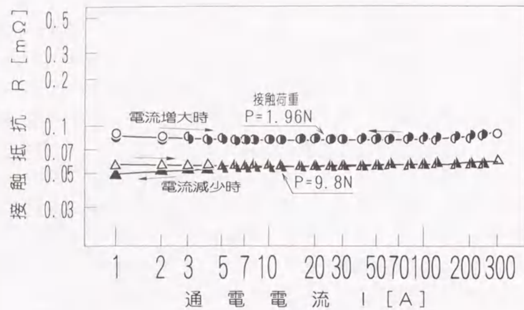
図 6. 5 銀接触子を用いた 接触抵抗と通電電流との関係
