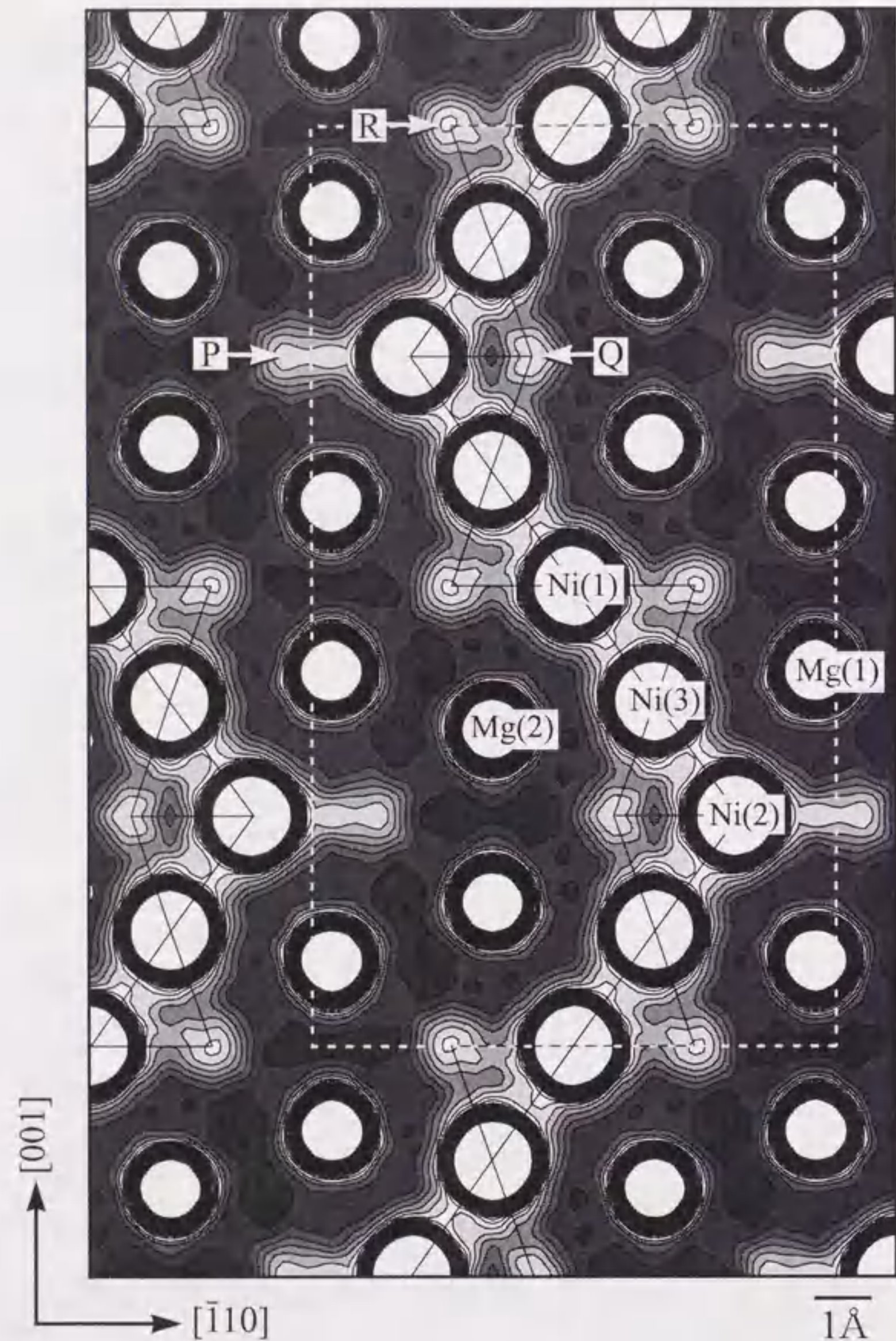
図5.33(b) \text{MgNi}_2 110面のMEM電子密度分布 0.0 \sim 2.0 \text{ e}\text{\AA}^{-3} , ステップ 0.05 \text{ e}\text{\AA}^{-3} 破線はユニットセルを, 実線はNi 4面体 の断面を表している
