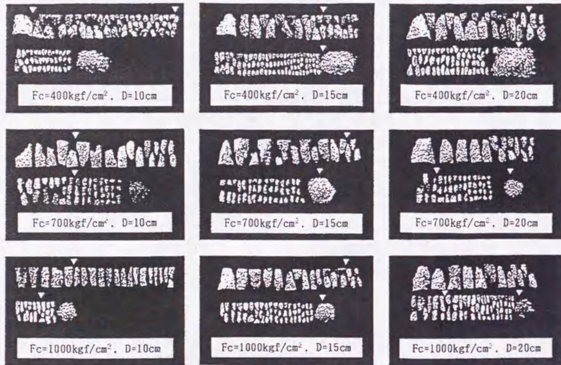
写真-2.3.1 一軸圧縮時のコンクリートの破壊状況
