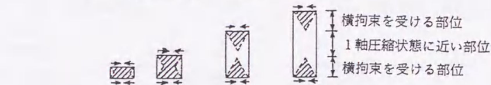
図-1.2.11 試験体の高さ/直径比 (H/D) と圧縮強度との関係 (端面摩擦有り)
