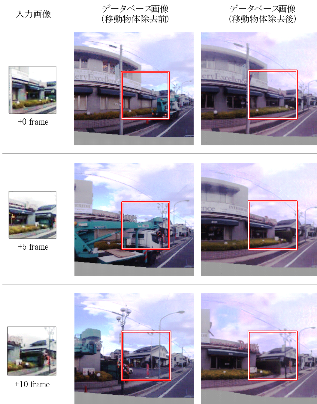
図 4.20 移動物体除去前後による画像間対応付け結果の違い。
