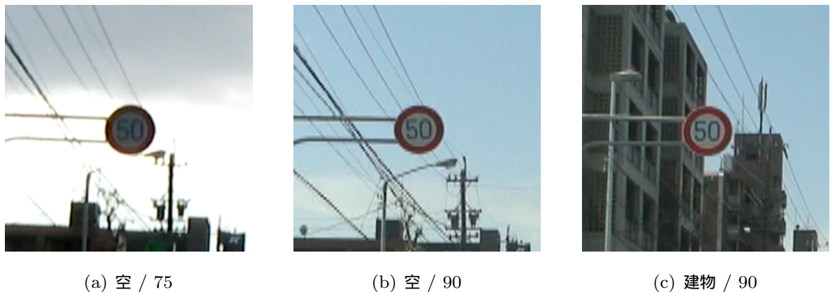
Fig. 3.1 視認性に影響を及ぼす要因（背景の種類 / 標識領域の平均明度値）
