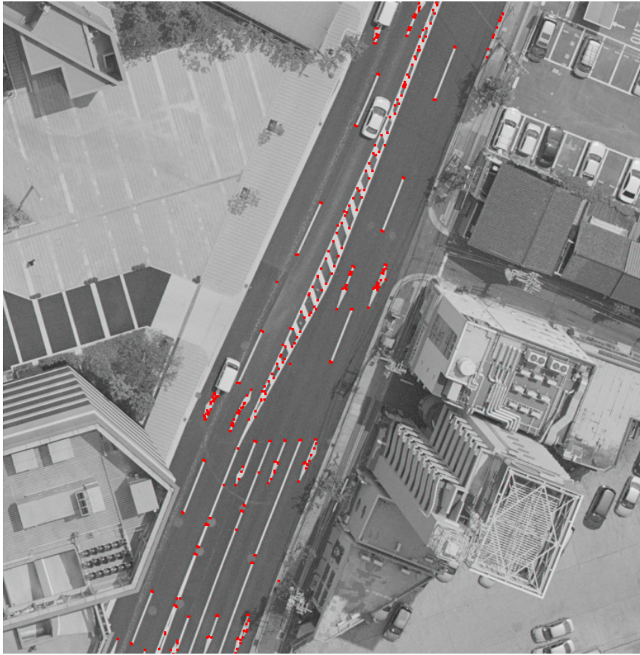
図 3.10 環境地図の例：自転車位置推定に用いる特徴点を赤丸で示す。
