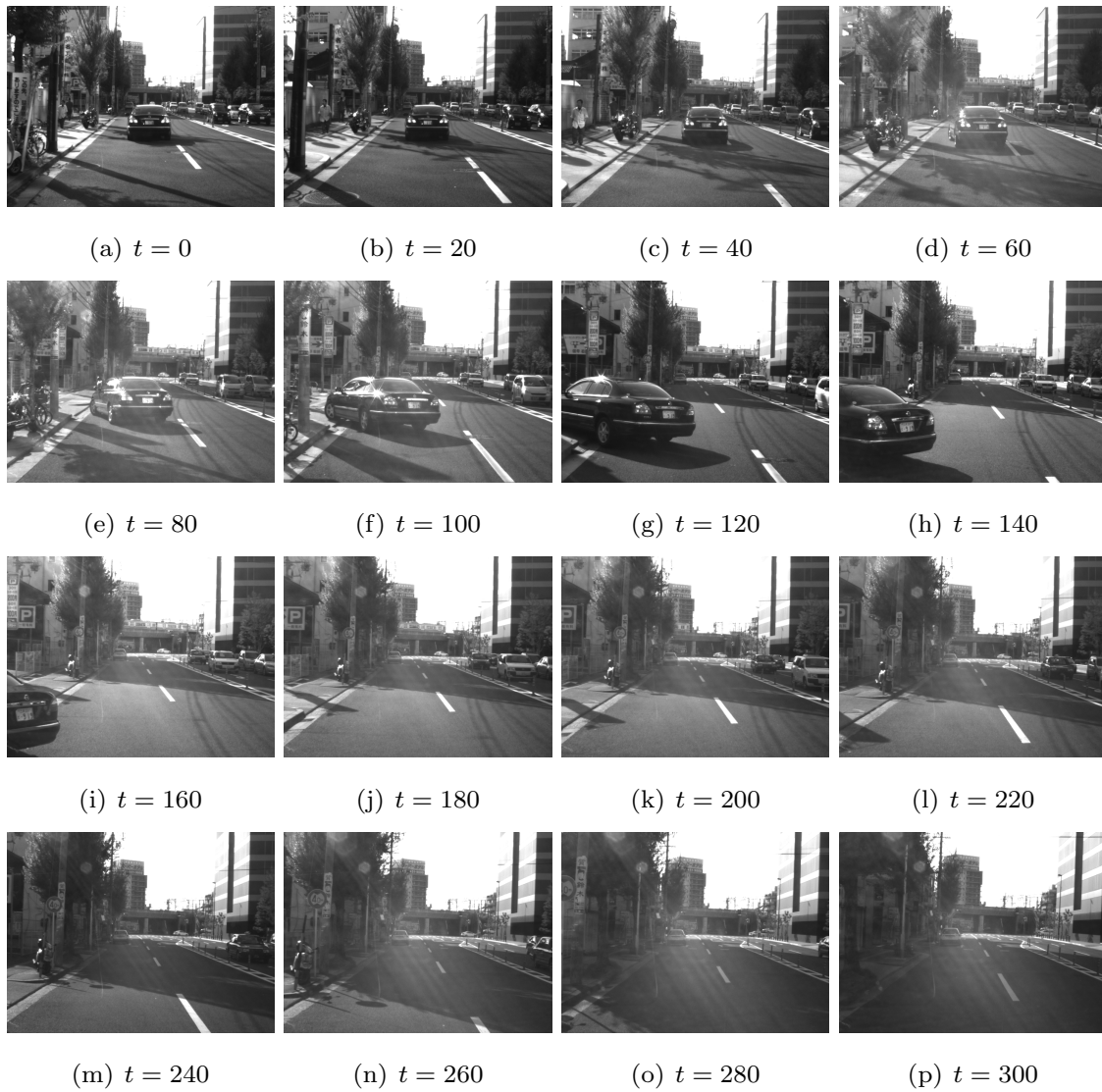
図 3.20 車載カメラ画像 (系列 3): 路面に強い影が発生する経路. また, 駐車車両を回避するための車線変更も含む.
