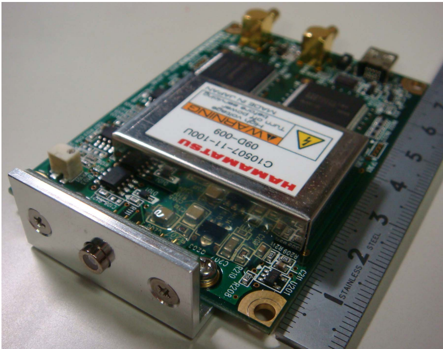
図 5.17: 実験に使用した MPPC モジュール C10507-11-100U
