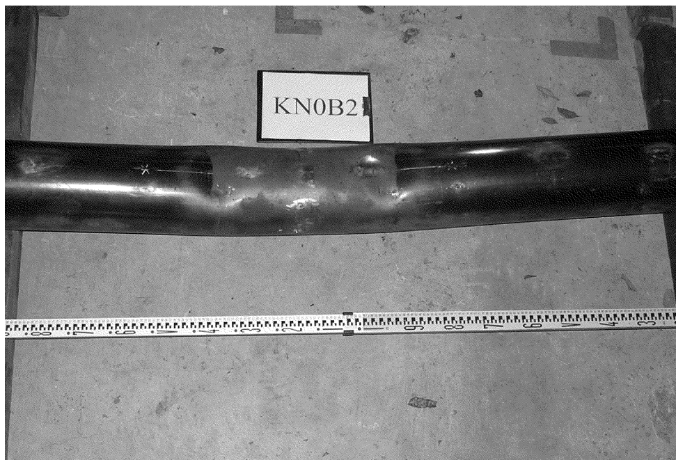
図 2.19 実験後の鋼管載荷点部のへこみ状況
