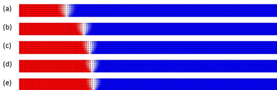
図4-1: 面内磁気異方性細線 ( t = 5 nm、 \beta = 0 ) の電流 ( u = 600 m/s) による磁壁移動の計算結果。(a) 0 ns., (b) 0.5 ns., (c) 1.0 ns., (d) 1.5 ns., (e) 2.0 ns. での磁化状態。赤い領域は右方向、青い領域は左方向に磁化しており、白い領域は x 方向(紙面方向)の磁化成分を持たないことを意味する。(この色の塗り分けは図4-2、図4-5でも共通である。)
