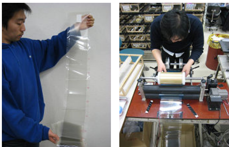
写真 3.3.1 : 左写真は、フィルムを粘着テープに貼り付けシート状にしたもの。右写真は、エマルジョンフィルムを粘着テープに貼り付けている様子。
