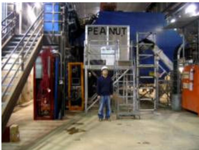
写真 3.5.1 : PEANUT 検出器。後方の青色の検出器は MINOS 前置検出器である。PEANUT はその直前に設置した。アルミ板でシールドしているが中は、SFT と ECC ブリックからなるハイブリッド検出器である。
