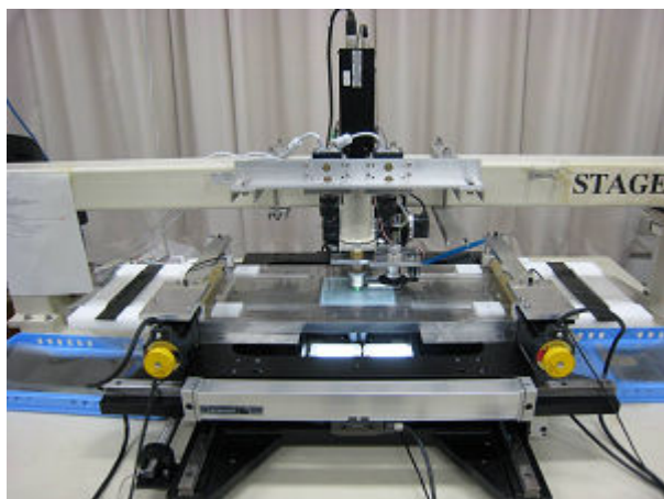
写真 3.3.3: プレートチェンジャー。UTS にシート状にしたエマルジョンフィルムを送る機能（モーター駆動）を付けたもので高速にフィルム交換を可能にしている。
