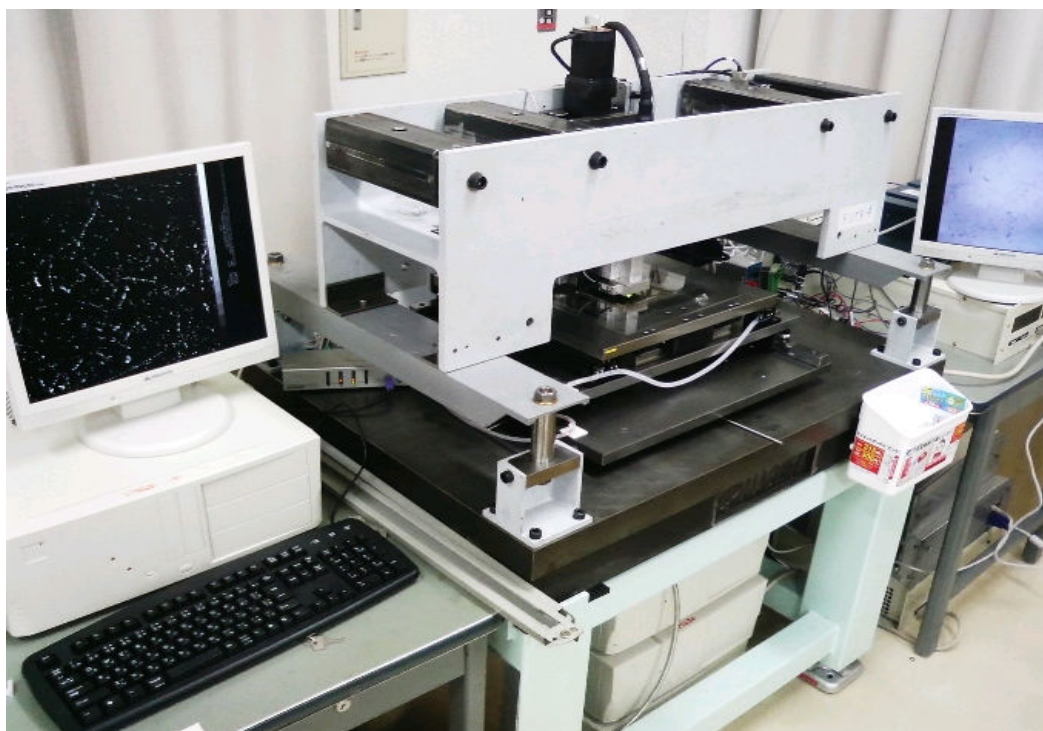
図 d.1：自動飛跡読み取り装置 S-UTS。現在 OPERA の解析のために 5 台が導入されている。
