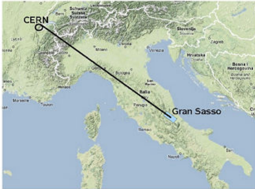
図 2.2.3 : CERN と Gran Sasso 研究所の位置関係。OPERA の検出器はイタリア・ローマ市郊外の Gran sasso 研究所に設置している。CERN の SPS で作られたニュートリノビームは 730km 離れた Gran sasso 研究所に向けて射出される。
