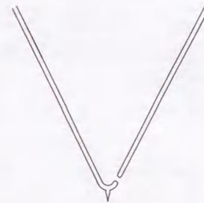
図 2.1 ヘアピンヒーターの溶断
