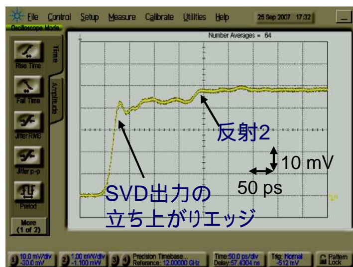
図 7-5. 1GHz のデータを入力した場合の SVD 出力波形の拡大図。
