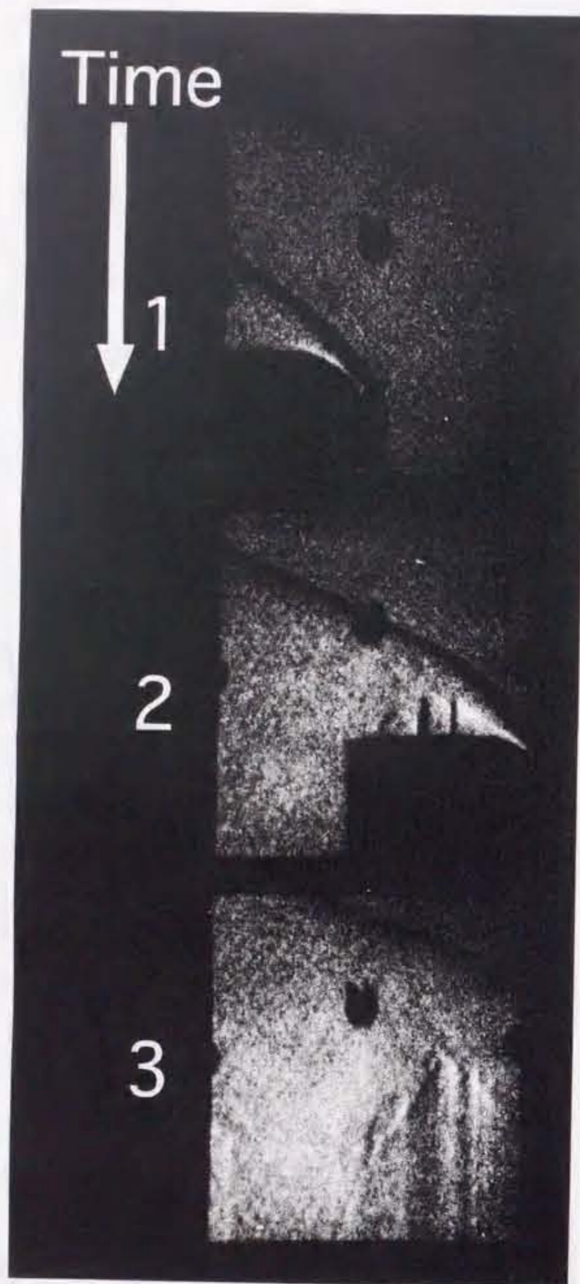
図3-8 実験で観測された振動燃焼の時間発展 フレーム間の時間間隔は 7.00 \mu\text{s} 。
